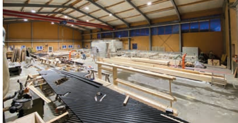
Die Werkshalle mit Abbundanlage, in der die Bauteile zehntel-millimetergenau zugeschnitten, bearbeitet und zur Vormontage hochgenau zusammengefügt werden.
