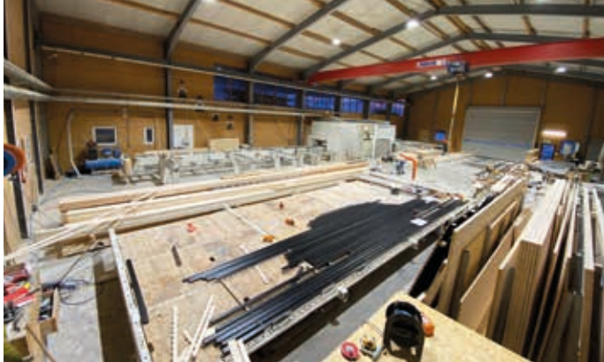
Die Werkshalle mit Abbundanlage, in der die Bauteile zehntel-millimetergenau zugeschnitten, bearbeitet und zur Vormontage hochgenau zusammengefügt werden.
